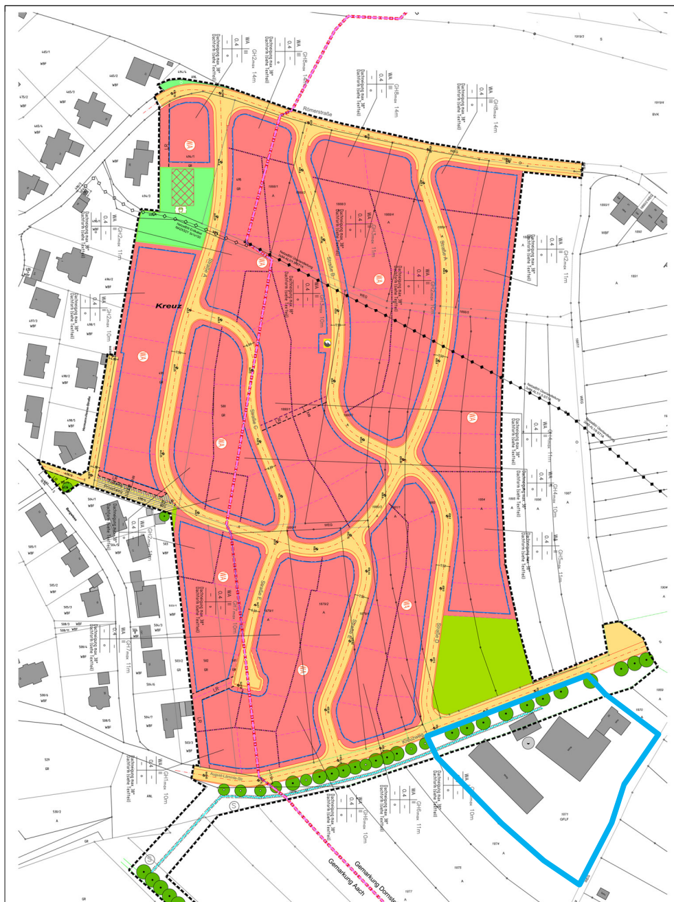
Abb. 1-1: Plangebiet „Kreuz II“ (farbig, ohne Retentionsbecken mit Zu- und Ablauf)) und der an der Südostecke des Plangebietes befindliche Tierhaltungsbetrieb Kreuzweg 25 (blau).
