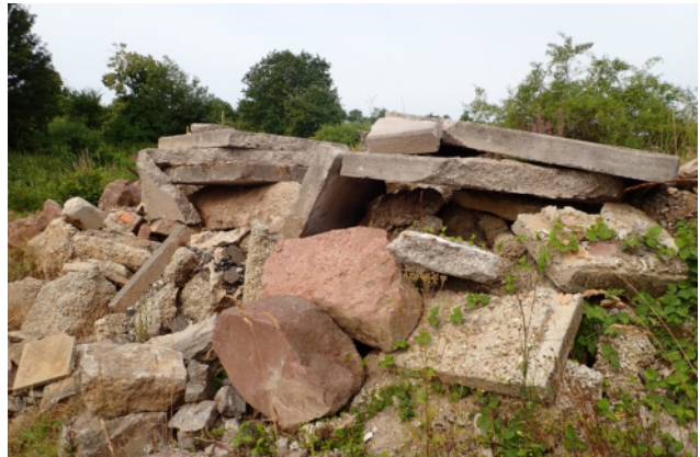
Abb. 35 Halde bestehend aus Blocksteinen und Betonplatten
